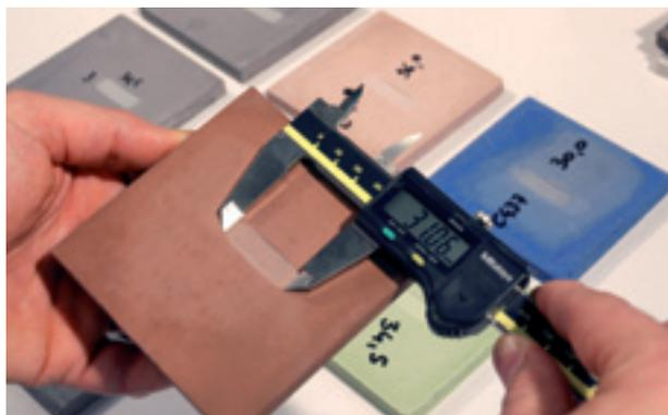
Испытание позволяет определить прочность поверхности образца, подвергаемого истиранию при помощи металлической пластины, выполняющей 50 оборотов при касании с поверхностью. Одновременно между образец и пластину поступает корундовая пыль (твёрдость по шкале Мооса: 9), струей 2 грамма на один оборот пластины.
